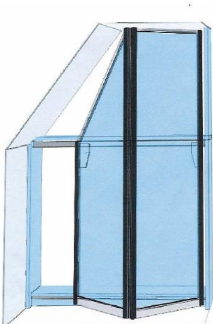
Obr.5. Vrchná koľajnica je montovaná na policu.
