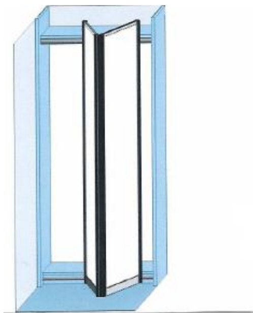
Obr.2. Väčšie odkrytie vnútra skrine- po jej otvorení je možné dostať sa do celej skrine. Po ich zatvorení sú dvere v jednej línii.
